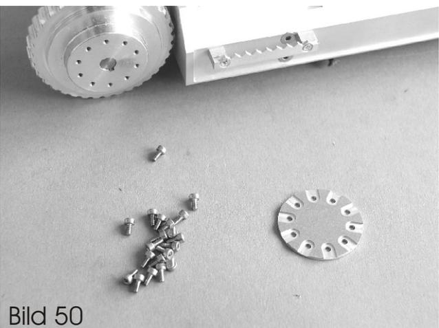
An die Antriebsräder werden jetzt die Deckel mit Schrauben Din 912 M2x4 montiert .
