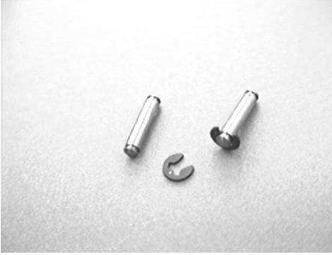
Auf die Bolzen werden **zunächst nur einseitig** die Bensingeringe Din 6799 montiert.
