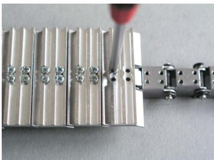
...und dann zusammen mit der Kettenplatte und 4 Schrauben DIN 7985 M2x4 auf dem Kettenwinkel angeschraubt.
