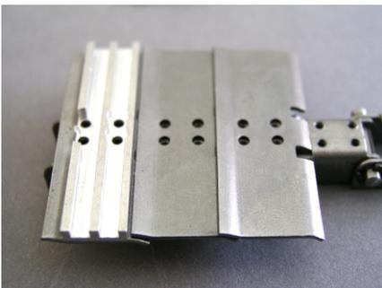
Falls Sie sich für die optionalen 3-Steg-Platten entschieden haben, werden diese nun wie auf dem Bild zu sehen auf die Kettenplatte gelegt...
