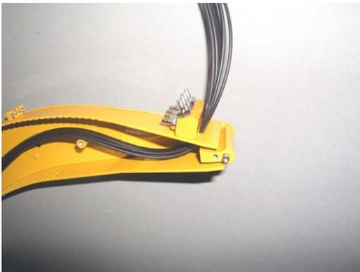
Schneiden Sie den bei dem Zubehör beiliegenden Schlauch mittig durch und schieben Sie die Schläuche für die Zusatzfunktionen zunächst durch die Öffnung im Oberen Deckblech des Monoblockauslegers.
