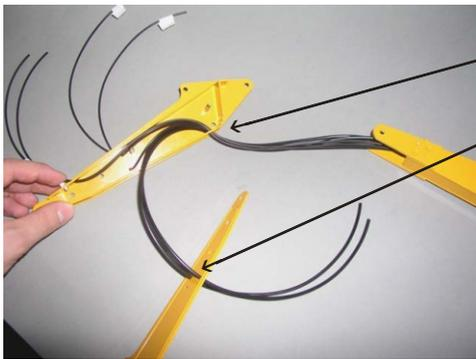
Die Schläuche der Zusatzfunktionen werden zunächst durch das untere Deckblech in den 3. Arm geführt.
