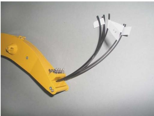
Bitte markieren Sie sich unbedingt die Schlauchenden, damit Sie später beim Anschließen an das Steuerventil wissen, welche Schlauchenden zueinander gehören.
