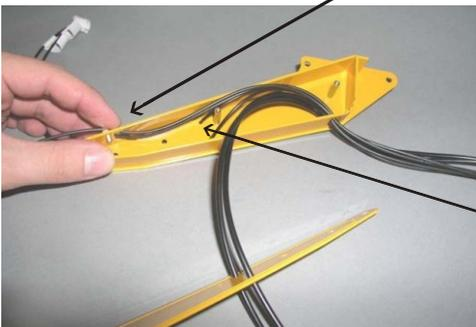
Die zwei Schlauchenden für das optionale Hydraulische Schnellwechselsystem werden durch das obere Deckblech und den dort montierten Schlauchhalter geführt.
