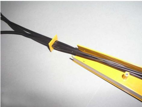
Schieben Sie das Füllblech über die Schlauchenden.
