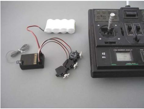
Jetzt müssen die Servos in ihre Grundstellung gefahren werden. Dazu schließen Sie bitte die Servos an Ihren Empfänger an, und schalten dann Fernsteueranlage und Empfänger ein.
