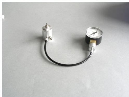
Das so vorbereitete Manometer kann jetzt in den Filter eingeschraubt werden .
