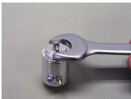
Zum öffnen der Filtereinheit benötigt man einen Maulschlüssel mit Schlüsselweite 27mm.
