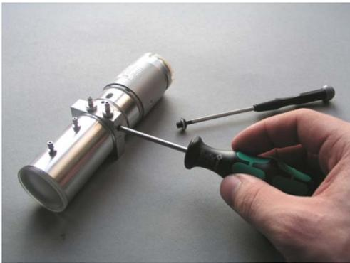
Hinter der Verschlußschraube befindet sich eine Madenschraube mit TORX-7.
