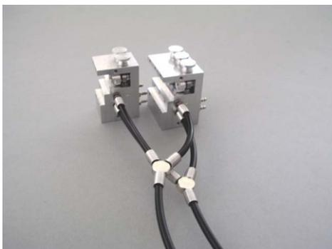
Falls Sie eine Hydraulikfunktion nachrüsten, müssen Sie das zusätzliche Steuerventil an Ihr bereits vorhandenes anschließen.
