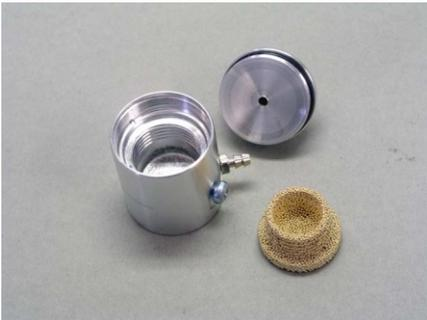
Reinigen Sie bitte auch die Einzelteile des Filters
