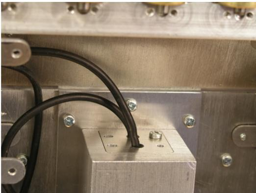
Zur Montage werden 6 Schrauben von der Befestigung des Drehkranzes mitbenutzt.
