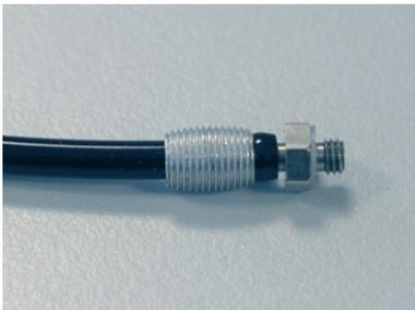
Zusammen mit der Sicherungshülse wird der Schlauch dann weiter auf den Nippel geschoben.
