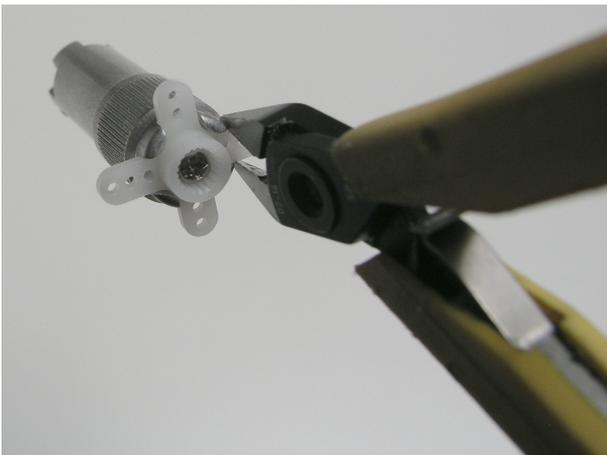
Nun können Sie relativ einfach die „Arme“ des Servo-Kreuz kürzen, in dem Sie diese mit einem Seitenschneider oder einem Messer um die Schablone herum abschneiden.
