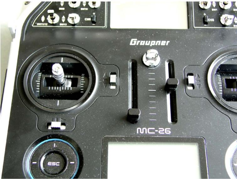
Der Pumpen-Regler durch einen Schieberegler am Sender auf die gewünschte Drehzahl eingestellt werden .
