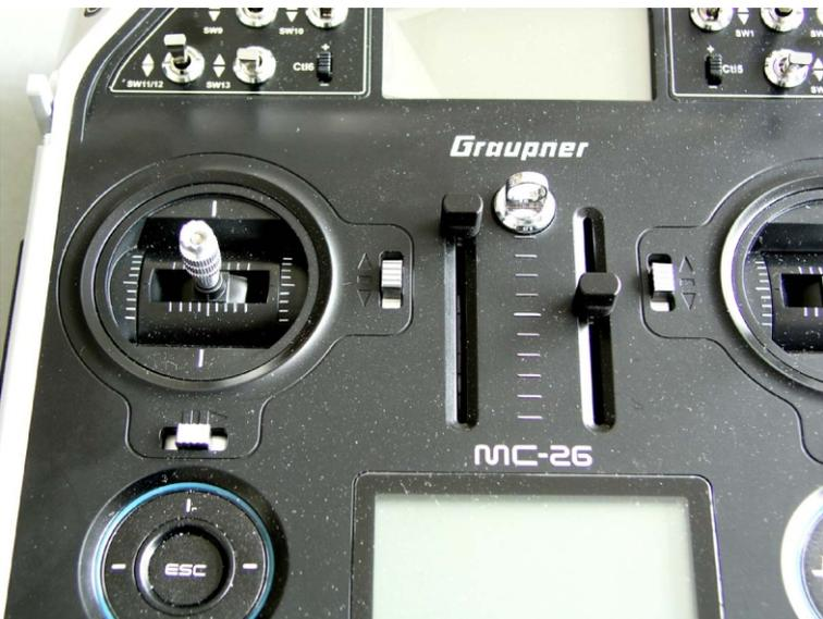
Bild zeigt Schieberegler in oberster Position . Dann läuft die Pumpe mit maximaler Drehzahl .
