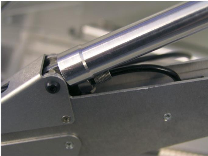
Verbinden Sie den Unteren Anschluss des Zylinders mit dem entsprechendem Schlauchende
