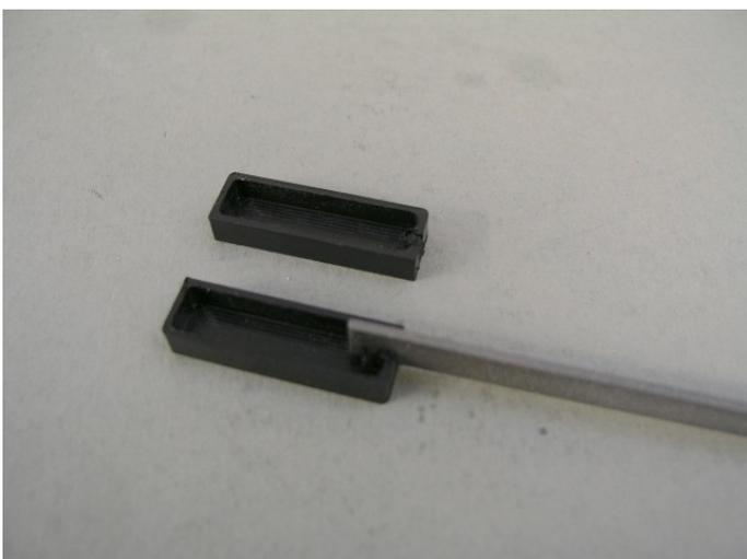
Entfernen Sie diesen Grat mit einer Feile oder einem Messer.
