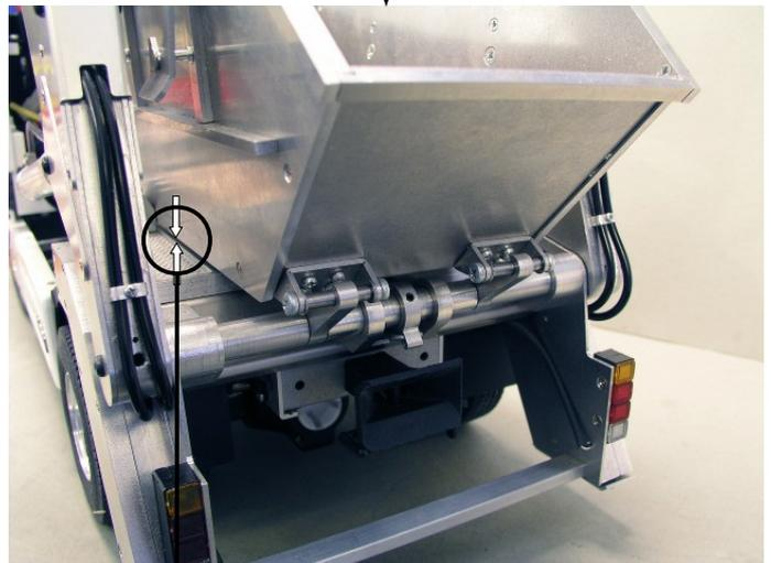
Das Hubgerüst muß in eine Stellung gebracht werden, in der sich die Mulde nur durch betätigen der Hubzylinder ein- und aushaken lässt.
