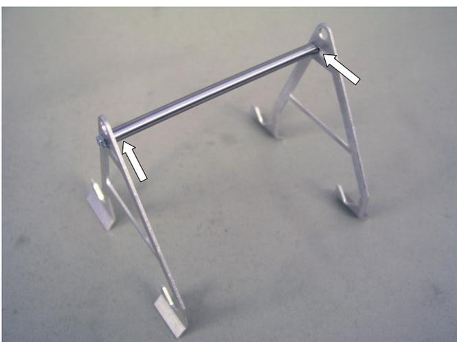
Die Verbindungswelle kann in dem Langloch der Muldenaufnahmen verschoben werden, um die Muldenaufnahme auszubalancieren.
