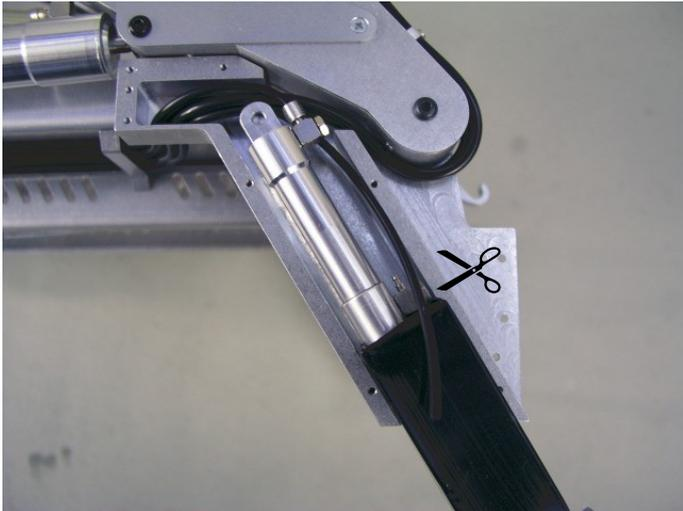
Kürzen Sie ggf. auch das andere Schlauchende, so dass es bis zum vorderen Anschluß des Zylinders reicht und verbinden Sie es mit ihm.
