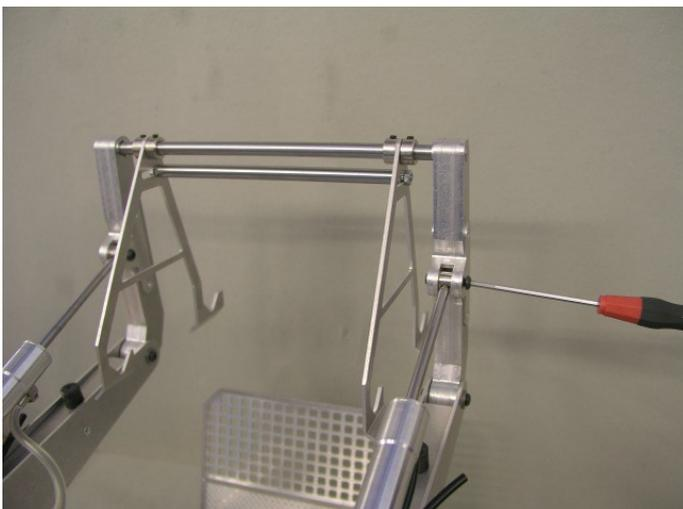
Nehmen Sie die Auslegerzylinder vorn nochmal los, indem Sie den Bolzen losschrauben und herausnehmen.
