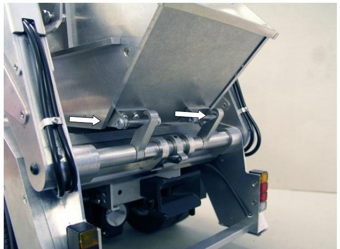
Achten Sie beim einfädeln der Mulde in die Haken darauf, daß Sie die Mulde vom Boden des Aufbaus abheben und nicht „über den Boden schlürfen lassen“.
