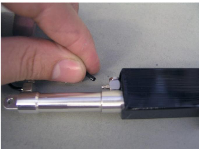
Entfernen Sie die Schlauchbrücke auf beiden Seiten des Zylinders.
