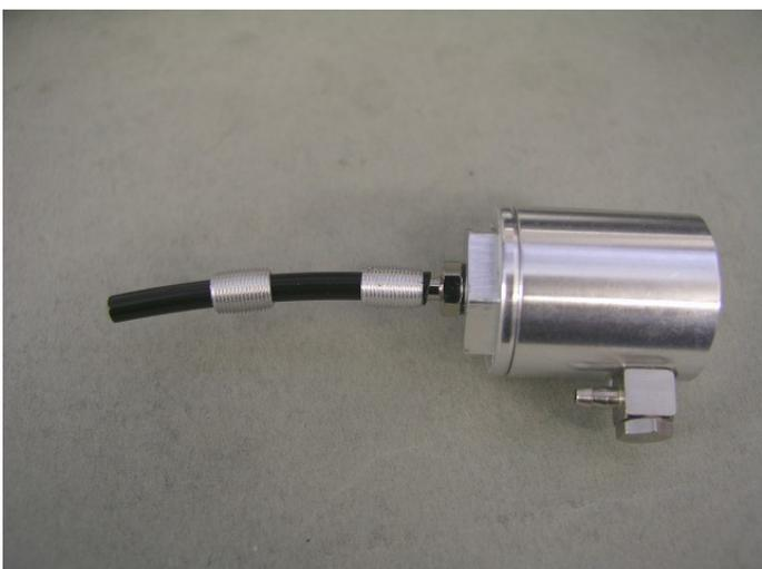
Schieben Sie eine weitere Sicherungshülse auf das Schlauchstück um es im nächsten Schritt auf dem Pumpenanschluss „P“ sichern zu können.
