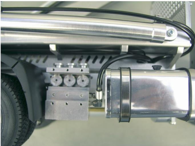
Die Schlauchenden auf der gegenüberliegenden Seite werden am Steuerventil angeschlossen.
