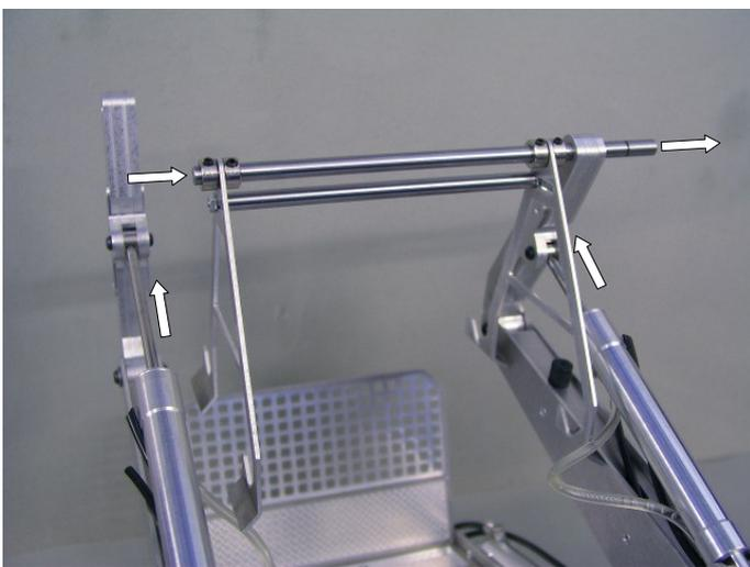
Bewegen Sie die Ausleger per Hand ungefähr in die Stellung, wie im Bild zu sehen. Nun kann die Auslegerverbindungswelle wie im Bild zu sehen durch einen der Ausleger geschoben werden.
