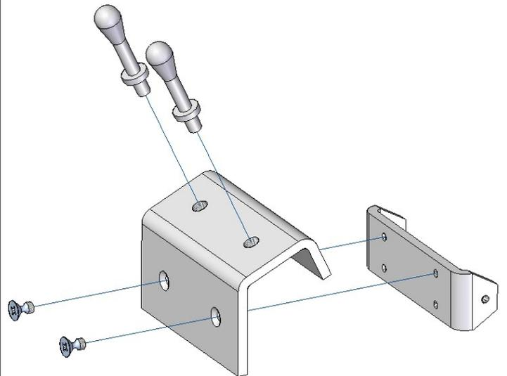
Bereiten Sie als nächstes bitte das Bedienpult vor in dem Sie ein Verbindungsblech mit 2x Schrauben DIN-965 M1,6x3mm daran befestigen und die Bedienelemente/Joysticks einschrauben.
