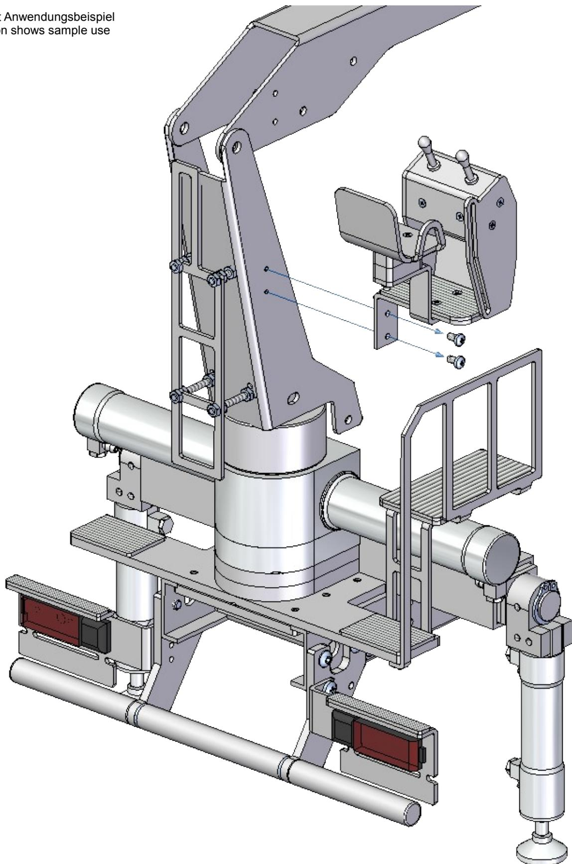
Der fertige Bedienstand kann dann mit den Schrauben DIN-7985 M2x4mm am Hauptarm des Ladekrans angeschraubt werden.
