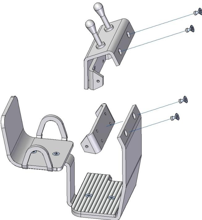
Befestigen Sie nun das zweite Verbindungsblech mit 2x Senkschrauben DIN-965 M1,6x3mm an dem Grundblech. Anschließend kann das Bedienpult ebenfalls mit dem Verbindungsblech verschraubt werden.
