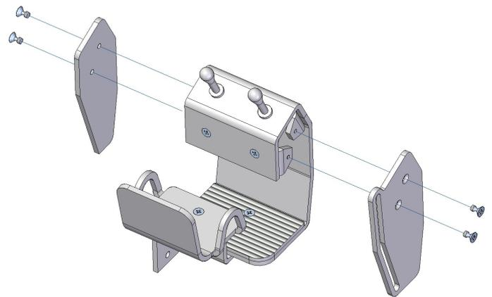
Zu guter Letzt können die Seitenteile mit Senkschrauben DIN-965 M1,6x3mm an den zwei Verbindungsblechen angeschraubt werden.
