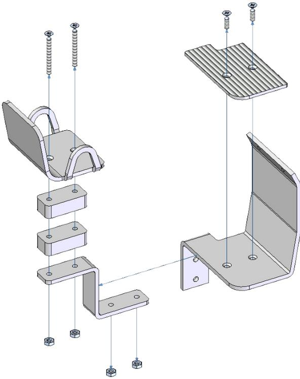
Bitte montieren Sie zunächst den Sitz mit zwei Schrauben DIN-965 M2x16( bzw.M2x8 mit nur einem Distanzstück) und Muttern M2.
