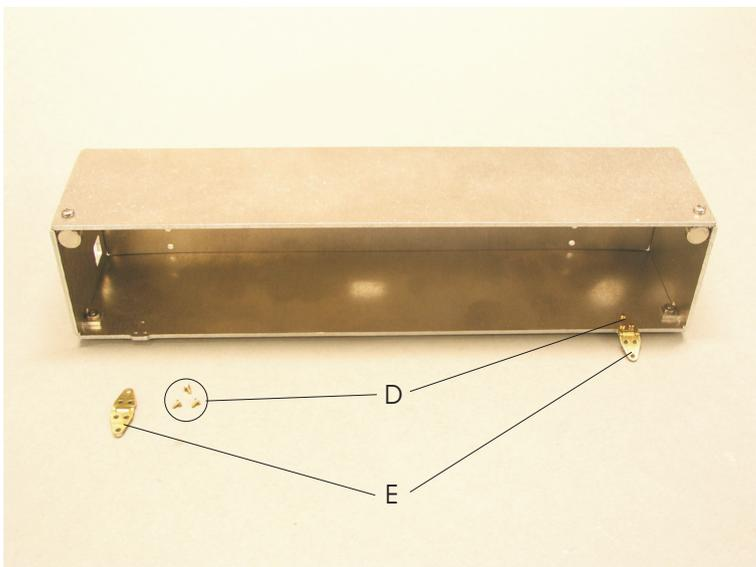
Bitte verschrauben Sie die Scharniere(E) mit den Schrauben(D) an dem Grundkasten. Die Scharnierwelle liegt in dem Bild nach unten. Die Schrauben nur ansetzen und noch nicht fest ziehen.
