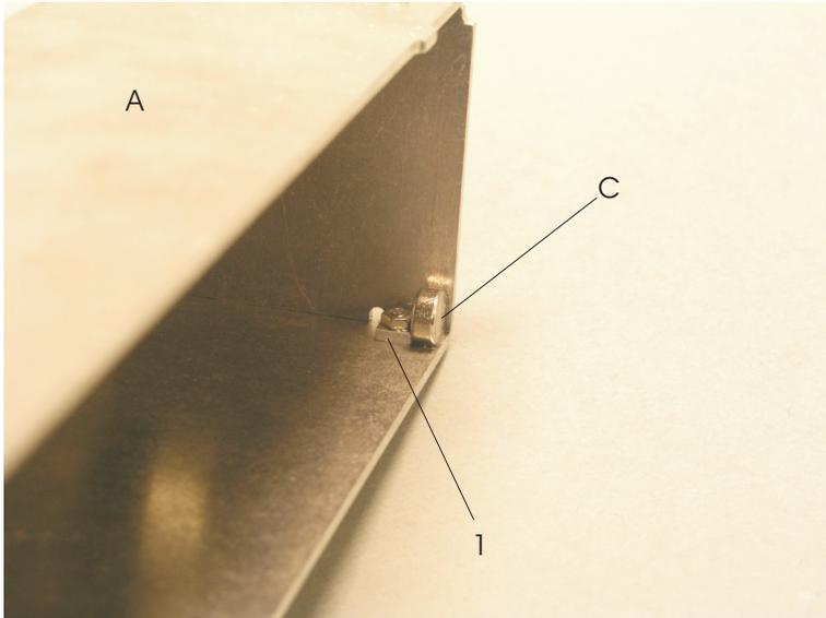
Bitte kleben Sie mit geeignetem Kleber die beiden Magnete(C) in die unteren Ecken des Kastens (A). Die Lasche (1) dient hierbei als Tiefenanschlag.
