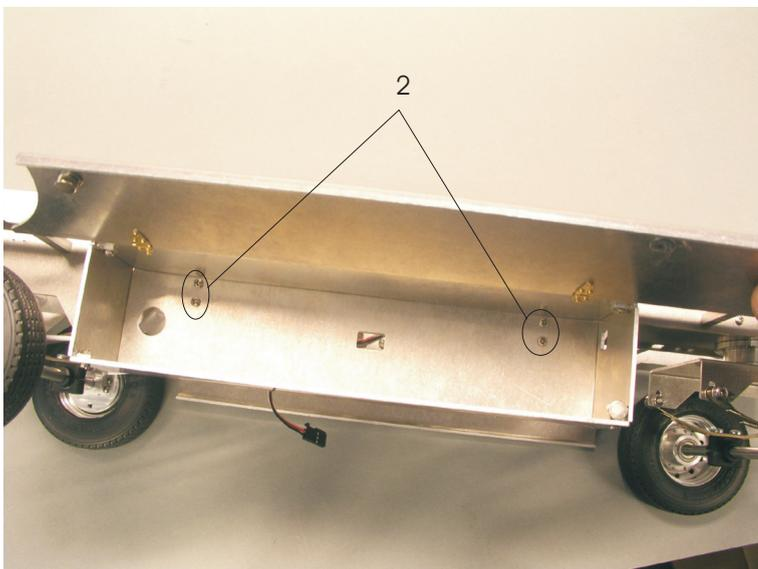
Bitte befestigen sie den Kasten mit den 4 Schrauben(2) die sie aus den Haltern heraus geschraubt haben.
