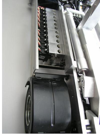
Unsere Steuerventile sind so konstruiert worden, daß das dafür notwendige Servo teilweise in den Ventilblock eingelassen ist, so daß das Ventil mit montiertem Servo nach außen einen möglichst geringen Platzbedarf haben sollte.
