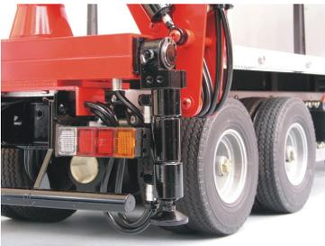
Der neue Kurzholzladekran , nach Vorbild der Fa Penz, ist auf einem Wedico Rahmen (713) befestigt. (Nicht im Lieferumfang enthalten) Die Abstützung ist seitlich ausfahrbar. Das Teleskop lässt sich 100 mm ausfahren.
