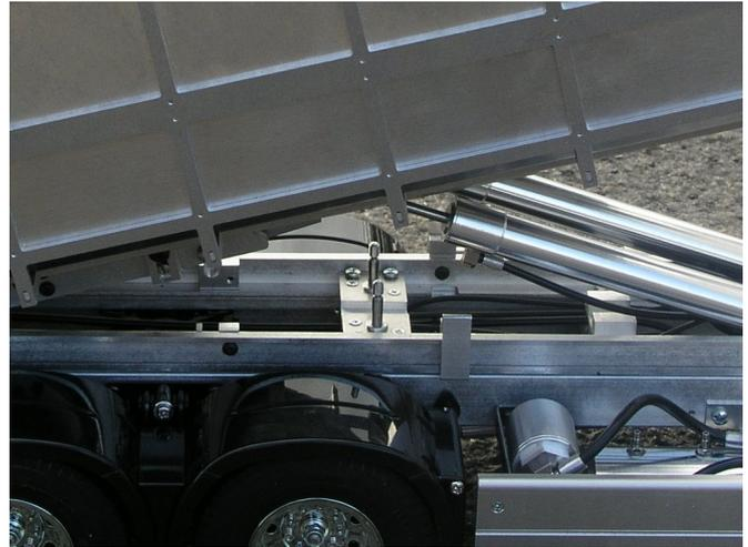
Mit dem Nachrüst-Set kann ein bereits vorhandener Abrollkipppaufbau nachträglich mit Hilfszylindern ausgestattet werden.
