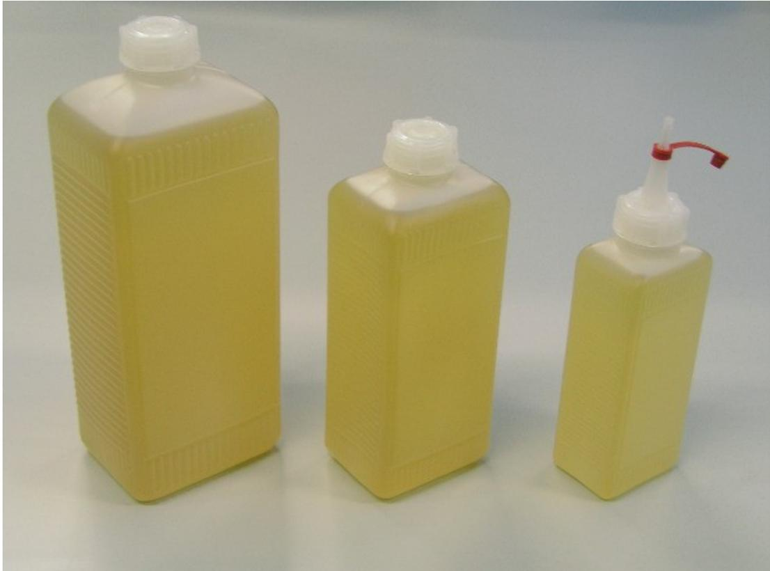
Wir verwenden als Hydraulikfluid ein Mineral-Öl basiertes Mehrbereichs-Hydrauliköl mit einem hohen Viskositätsindex (HVI).
