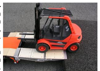
Mit unserem Rampen – Umbausatz kann der CARSON Goldhofer - Tieflader mit hydraulisch betätigten Rampen ausgerüstet werden. Die benötigten Hydraulik-Komponenten finden Platz in der Mitte des Unterbodens unter dem Tieflader und belegen somit keinen zusätzlichen Platz (z.B. in der Pritsche).
