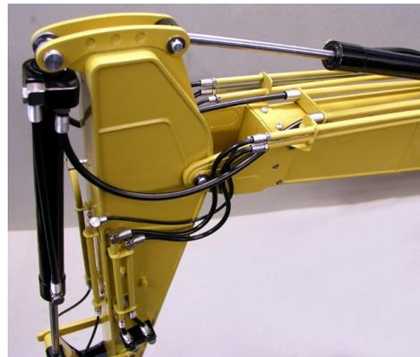
Die zusätzlichen Hydraulikfunktionen müssen natürlich irgendwie auf den Armen verlegt werden. Außerdem muss man die Möglichkeit haben Anbaugeräte mit Hydraulikfunktionen anzuschließen und auch wieder abzunehmen. Dazu dient diese Erweiterung.
