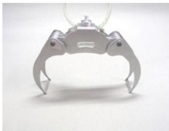
Holzgreifer (fertig montiert):
