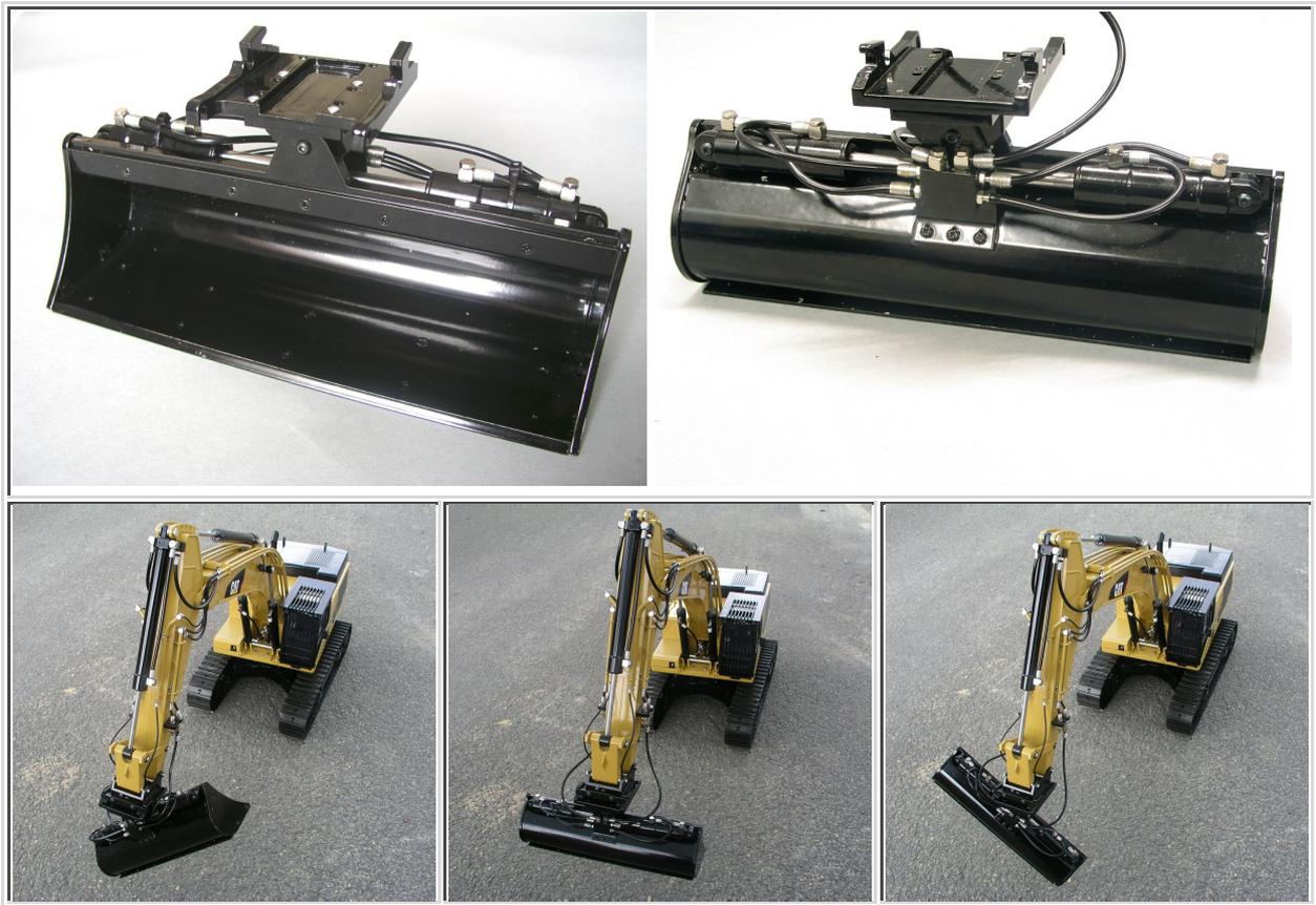
Mit dem schwenkbaren Grabenräumlöffel gibt es nun eine weitere vielseitig einsetzbare Schaufel für den WEDICO Bagger CAT-345D.
