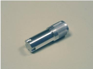
Einstellwerkzeug für Steuerventilexcenter
