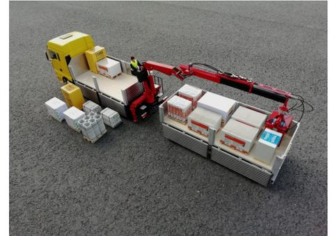
Ab sofort bieten wir von unserem Klappladekran auch eine Variante zum Bau eines Baustoff-Fahrzeugs an, welche mit einer Rahmen-Verlängerung hinten am Fahrzeugrahmen angebracht wird. Im Unterschied zum normalen Klappladekran wird die Baustoff-Variante unseres Klappladekrans mit einem 360° Schwenkzylinder statt des üblichen 270° Schwenkzylinders ausgeliefert.
