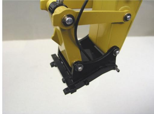
Das hydraulische Schnellwechselsystem ist dem Original von CATERPILLAR nachempfunden. Die Teile sind bereits lackiert bzw. pulverbeschichtet.
